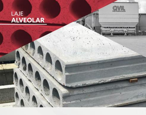
A laje alveolar é uma estrutura de concreto com cavidades que reduzem peso sem comprometer resistência. Com protensão, potencializa suas características permitindo vencer vãos maiores, dispensando escoramento. Os benefícios da Laje Alveolar incluem redução de peso, isolamento térmico/ acústico, versatilidade e economia.
